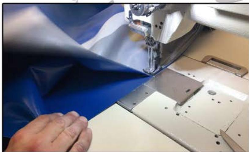
A continuación, pasamos a montar pieza por pieza el hinchable, realizando dos pasadas de costura de doble puntada, en cada una de las uniones de las piezas, anclajes, cremalleras... para asegurar una gran durabilidad de nuestro producto.
